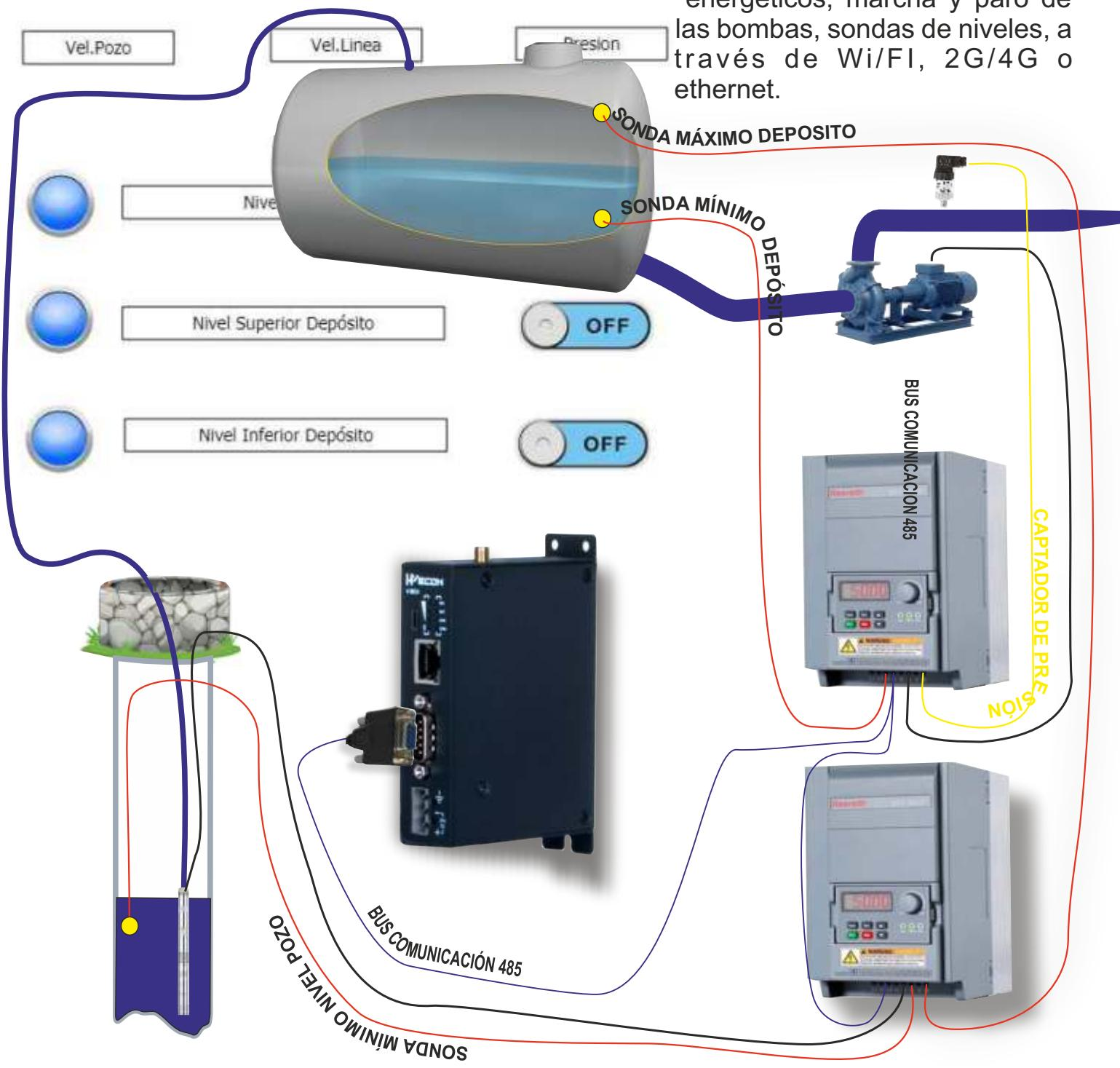
Sistema para el control y activación de todos los parámetros de un sistema de regadio sin plc, visualizando y cambiando parámetros de:
